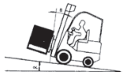
Cargas en rampa.
